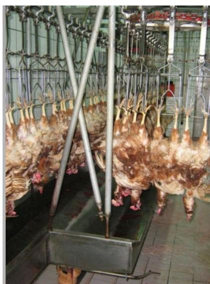
Обескровливание птицы проводят наружным способом в машине для убоя с помощью дисковых ножей. Обескровливание тушек и сбор крови происходит в ванне, после чего тушки направляются в ванну для тепловой обработки
