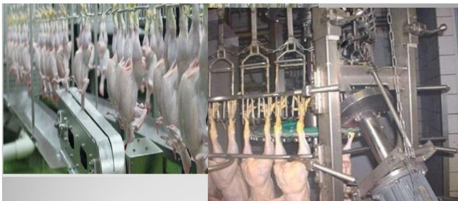
Особенностью машины для отделения голов является наличие специальных рабочих органов, исключающих повреждение крыльев и обеспечивающих
