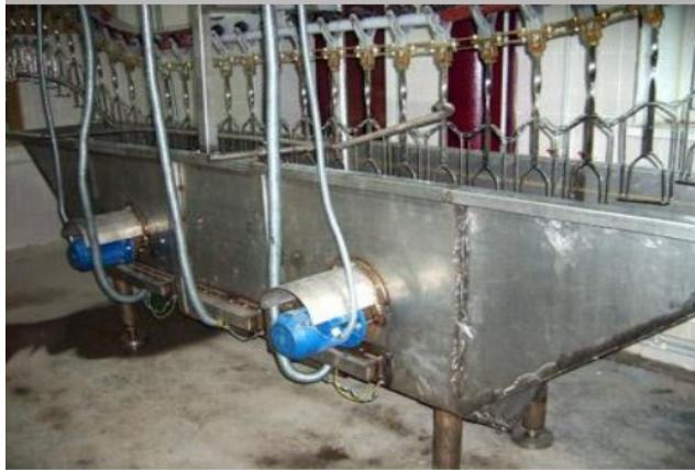
Ванна состоит из секций, внутри каждой смонтирован ороситель, а воду в них подогревают острым паром
