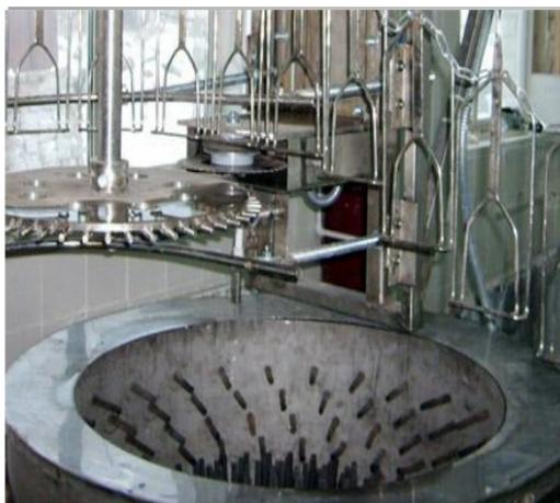
Каждый дисковый ряд автономно регулируется по высоте, ширине и углу поворота относительно своей продольной оси. При обработке тушек в эти машины непрерывно подается горячая вода температурой до 45 °С. При необходимости оставшееся мелкое оперение и пух удаляют вручную,
