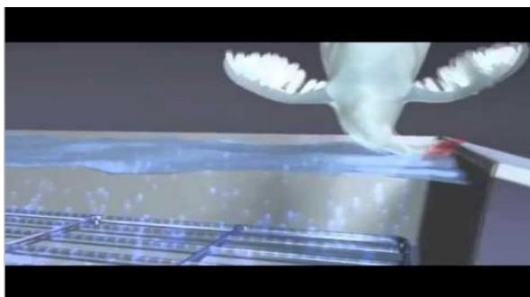
Рисунок 1. Схема машины для электрооглушения птицы.
